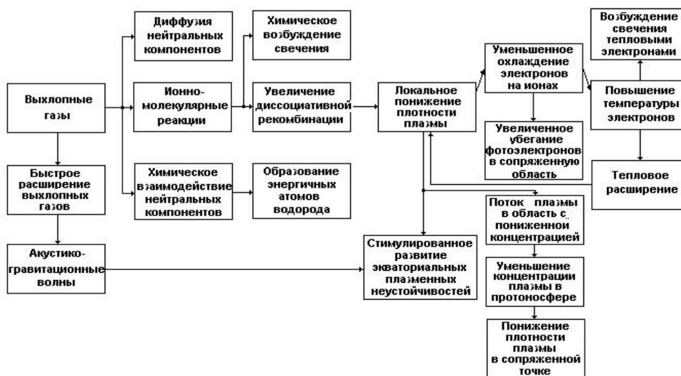
Рис. 3.27. Схема физических процессов и последствий запусков РКТ на верхнюю атмосферу (Адушкин и др., 2000)
