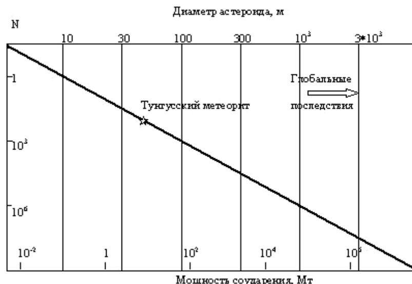
Рис. 3.37. Частота  $N$  столкновения астероидов с Землей в функции их размеров или мощности соударения
